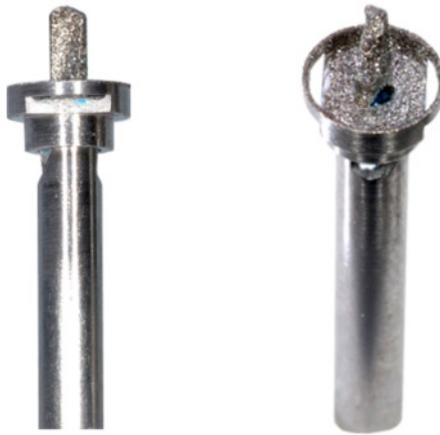
Abb. 37: Pilotschleifer des Würzburger Systems: mit diesem Werkzeug werden das zylindrische Basisloch und die umlaufende Nut geschaffen.
