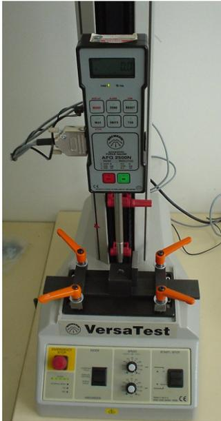
Abb. 17: VersaTest mit AFG-2500N und eingespannter Probe vor einem Extraktionsversuch
