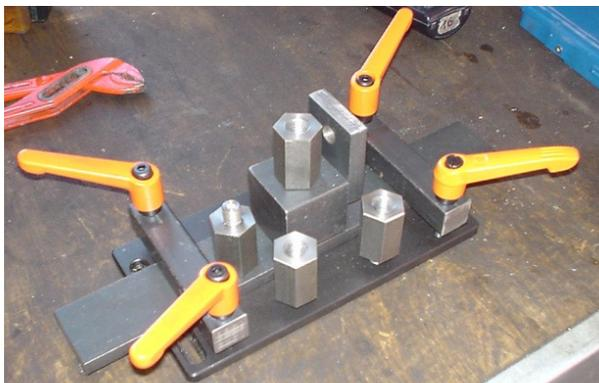
Abb. 15: Probenträger in 0°-Position
