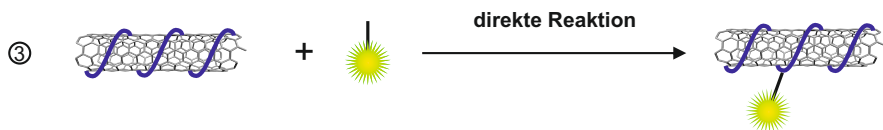
Abbildung 6.14: Funktionalisierungsschema nach Route ③ als Ausschnitt aus Abbildung 6.1. Hier erfolgt eine direkte Kupplung des Fluorophors an individualisierte ssDNA-SWNT-Konjugate. Die dazu notwendigen reaktiven Gruppen werden durch spezielle Vorbehandlung eingeführt.
