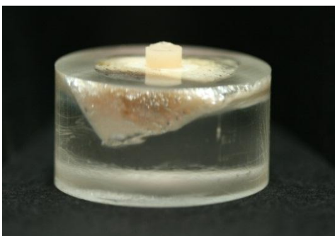
Abbildung 80: Für den Schertest nach ISO 11405 präparierter Rinderzahn.
