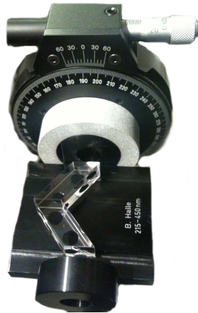
Abbildung 3.11.: Doppel-Fresnelrhombus als \lambda/2 -Platte zur Drehung der Polarisations ebene linear polarisierten Lichts. Die beiden Rhomben aus Suprasil Quarzglas sind in optischem Kontakt aufgeklebt und in einen Rotationstisch gespannt. Dies ermöglicht, vertikal linear polarisiertes Licht beim Anregelaser einzustellen.
