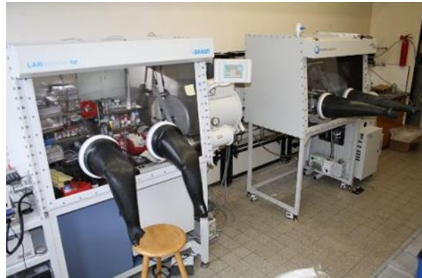
Abbildung 5: Handschuhkästen – LABMaster SP von MBRAUN (links) und PureLab HE von INNOVATIVE TECHNOLOGIES (rechts).
