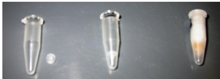
Abbildung 2-1: Einbettung von P.can Holz in 1,5 ml-Reaktionsgefäßen. Es wurden kleine Plastikscheiben verwendet, um in den 1,5 ml-Reaktionsgefäßen für die Platzierung der Pappel-Aststücke eine gerade Abschlussfläche zu erreichen.
