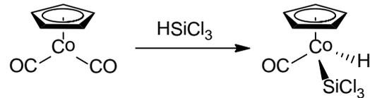
**Schema 36:** Aktivierung von Trichlorsilan mit  $[(\eta^5\text{-C}_5\text{H}_5)\text{Co}(\text{CO})_2]$ .
