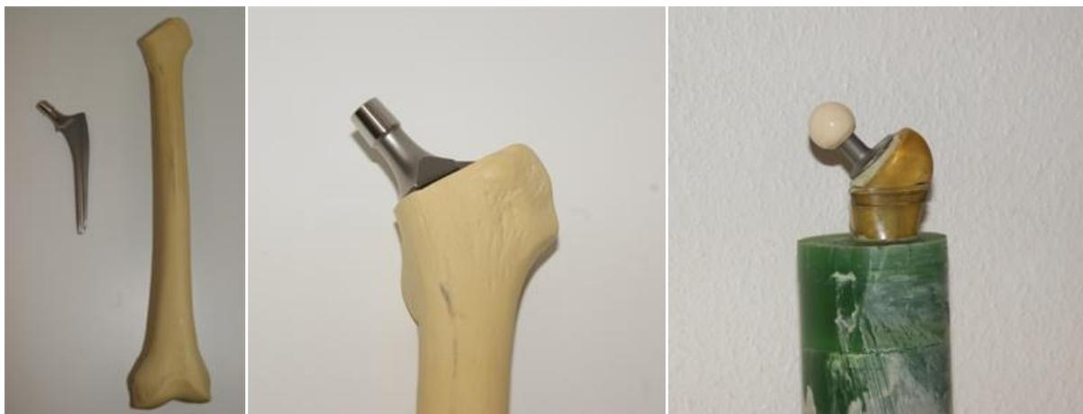
**Abbildung 5:** Darstellung des Femurschaftimplantats mit künstlichem Femur. Ummantelung mit Technovit für die Dauerschwingprüfung an einer servohydraulischen Materialprüfmaschine.
