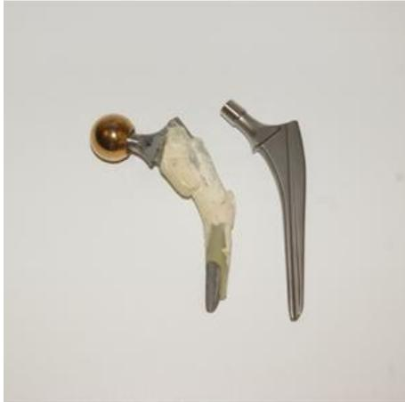
**Abbildung 21:** Deformiertes Femurschaftimplantat, das zum Abbruch der Dauerschwingprüfung führte.
