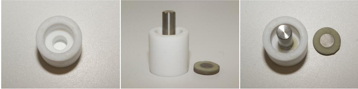
**Abbildung 6:** Teflonform und Edelstahlzylinder zur Herstellung der Prüfkörper für den vereinfachten Hüftprüfstandversuch. Querschnitt eines Prüfkörpers nach erfolgter Hochdruckwasserstrahlschneidetechnik.
