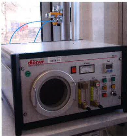
Abbildung 15: Plasmaofen zur Aktivierung von Oberflächen
