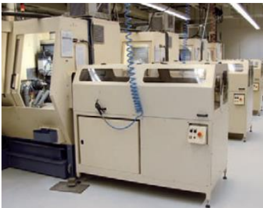
Abbildung 4.4: vier Tonnen schwere Hochleistungsfräsmaschine für vorgesinterte Zirkoniumdioxidrohlinge [143]
