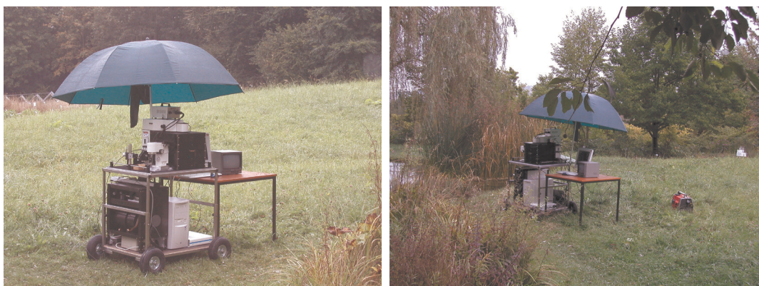
Abb. 3.10: Mobile Raman-Apparatur bei leichtem Nieselregen im Botanischen Garten der Universität Würzburg aus verschiedenen Perspektiven.
