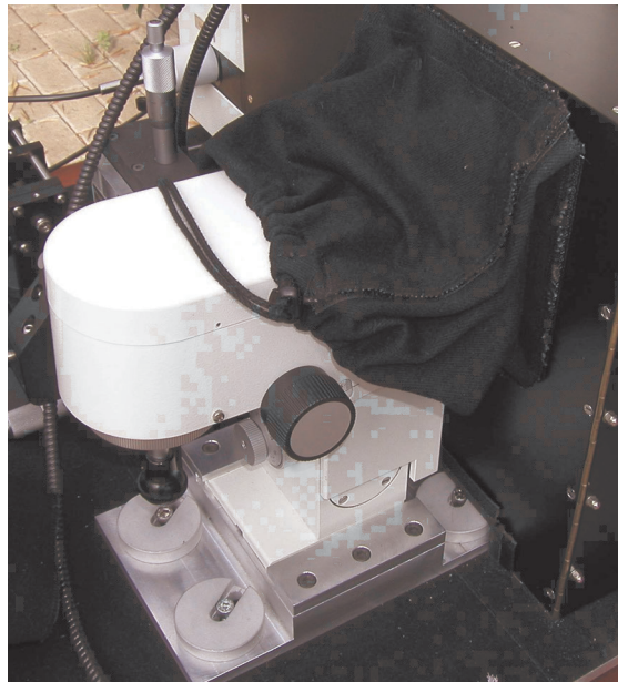
Abb. 3.5: Stoffmanschette zur Abdeckung der Öffnung für den Mikromanipulator im Licht- und Windschutz des Mikroskopmoduls.
