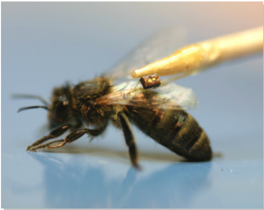
Abbildung 3: Aufkleben eines RFID Chips mittels Schellack
