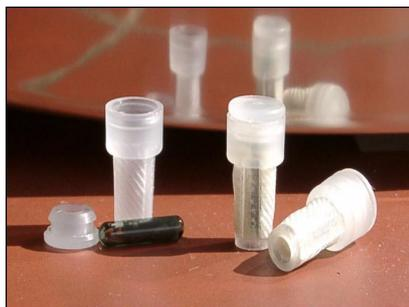
Abbildung 2.27: IRORI MikroKan, das bis zu 30 mg Polymer aufnehmen kann mit einem Tag zur Identifizierung der auf dem Harz synthetisierten Verbindung.
