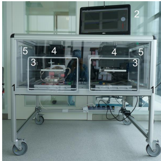
Abbildung 45: Inkubatorwagen für die gute Herstellungspraxis (1) Steuerungseinheit/Kontroller (2) Ausgabegerät (3) Inkubatorkammer (4) Pumpen (5) Heizung
