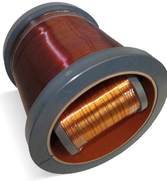
Abbildung 3.6: Präpolarisationsspule mit innen liegender, senkrecht orientierter Empfangsspule.
