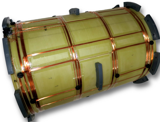
Abbildung 4.4: Offenes Gradientensystem mit allen Spulen S1-S4. Kupferleitungen wurden auf einen Zylinder gewickelt und mit PVC-Schrauben in jeder Ecke fixiert (1.5 cm große schwarze Schraubenköpfe, die teilweise wegen Überlappung wieder entfernt wurden).
