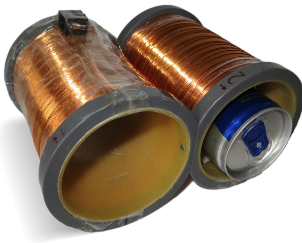
Abbildung 3.4: Empfangsspule, Gradiometer 1. Ordnung mit Musterprobe.
