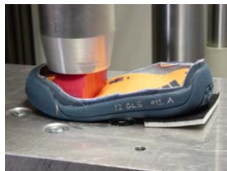
Abbildung 3: Standardmessverfahren zur Bestimmung der Dämpfungsparameter eines Sportschuhs mittels Instron TM -Testmaschine
