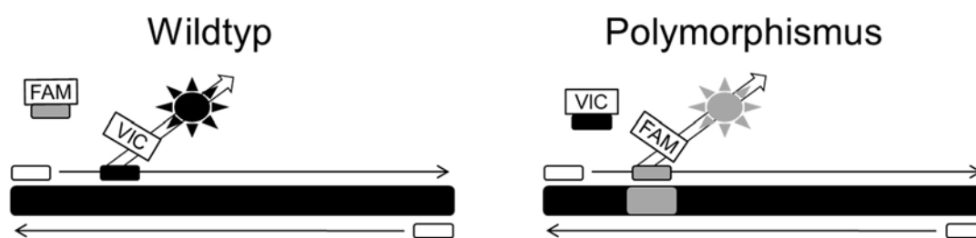
Abbildung 5: Schematische Darstellung der allelischen Diskriminierung. VIC und FAM: An die TaqMan®-Sonde gebundene Fluoreszenzfarbstoffe. Die Sonne steht indikativ für ein entstehendes Fluoreszenz-Signal bei Abbau der TaqMan®-Sonde.
