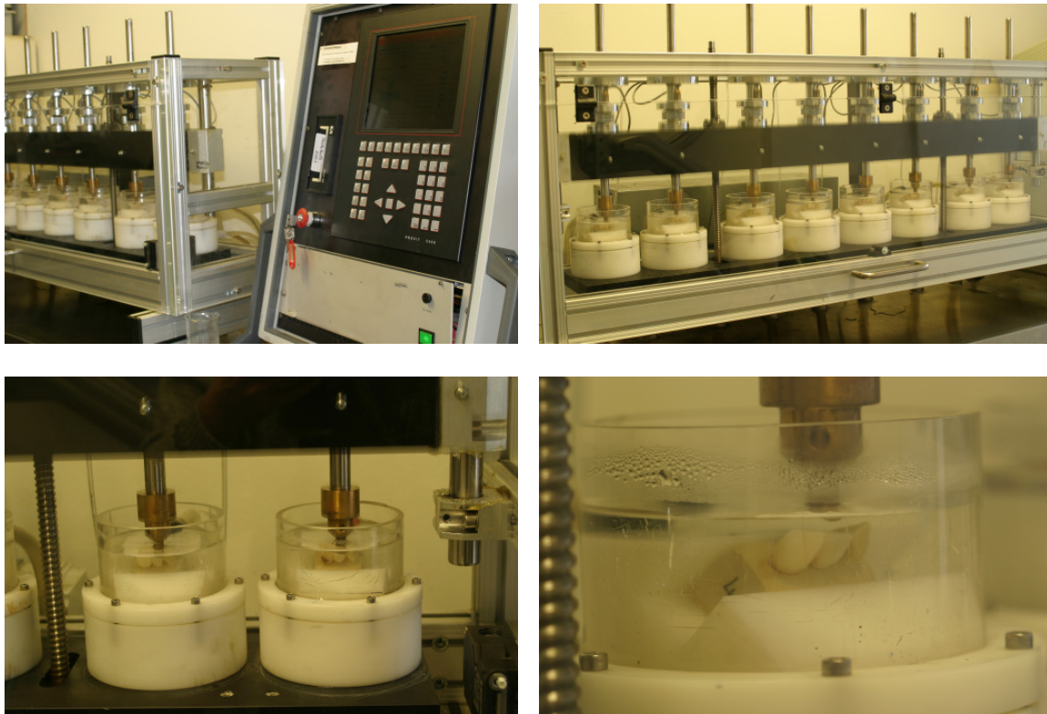
Abb. 12: Prüfkörper während der dynamischen Belastung im Zweiachsen-Kausimulator
